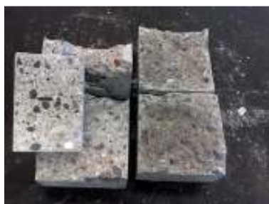
44: Prerez betona iz recikliranega agregata
