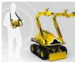
Sliki 12 in 13: Robot za rušenje na daljinsko upravljanje
