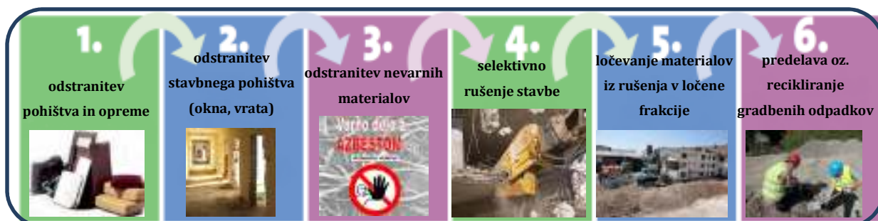
Slika 2: Grafični prikaz poteka selektivnega rušenja
